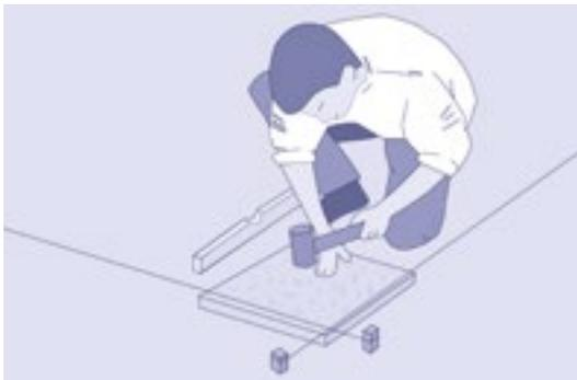
La première plaque doit être posée dans du mortier, afin que la plaque ne glisse pas lors de l'alignement.
